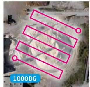
Como se puede ver en la imagen de la derecha, la menor superposición frontal y lateral de la solución de georreferenciación permiten al VANT cubrir más terreno de forma más rápida, en contraste con la solución de triangulación aérea de la izquierda. La tabla siguiente muestra la cantidad real de tiempo empleado y el número de imágenes capturadas.
